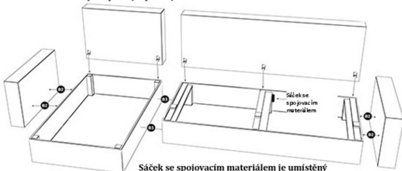
**Sáček se spojovacím materiálem je umístěn v úložném prostoru sedacího dílu (viz.obrázek)**
