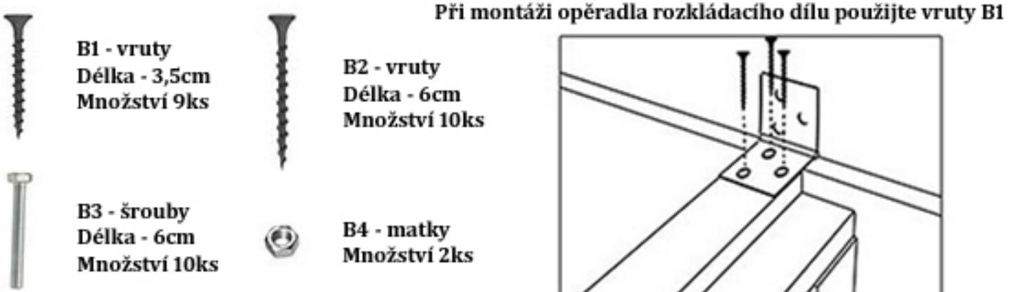
Při montáži opěradla rozkládacího dílu použijte vruty B1
