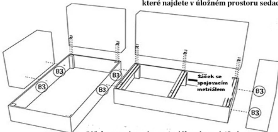
Sáček se spojovacím materiálem je umístěný v úložném prostoru sedacího dílu (viz.obrázek)
